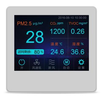
主界面显示内容有: PM2.5、CO<sub>2</sub> 、TVOC、温度、湿度、滤网剩余。控制按钮有: 开/关、风速三档、新风/净化、手动/自动、设置,其中风速三档、新风/净化只有在手动模式时,才可以手动切换,自动模式时设备根据预先设置好的检测数据自动运行。
